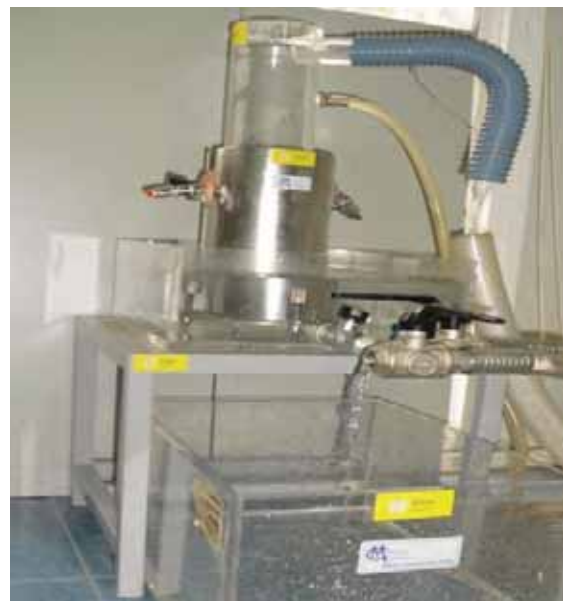
Foto 3: Equipo de medida de la permeabilidad vertical.
