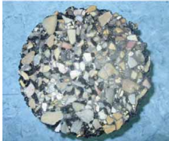
Fotos 7 y 8: Mezcla porosa árido grueso 70 % cúbico + 30 % lajoso.
