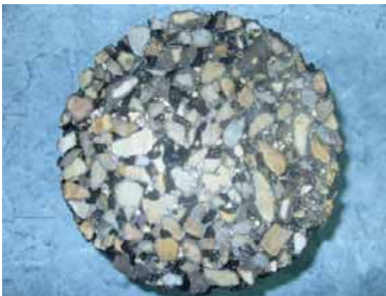
Fotos 5 y 6: Mezcla porosa 100 % árido grueso cúbico.
