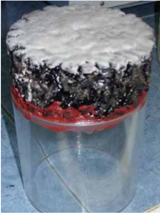
Foto 4: Probeta con la cara parafinada para efectuar la permeabilidad horizontal.
