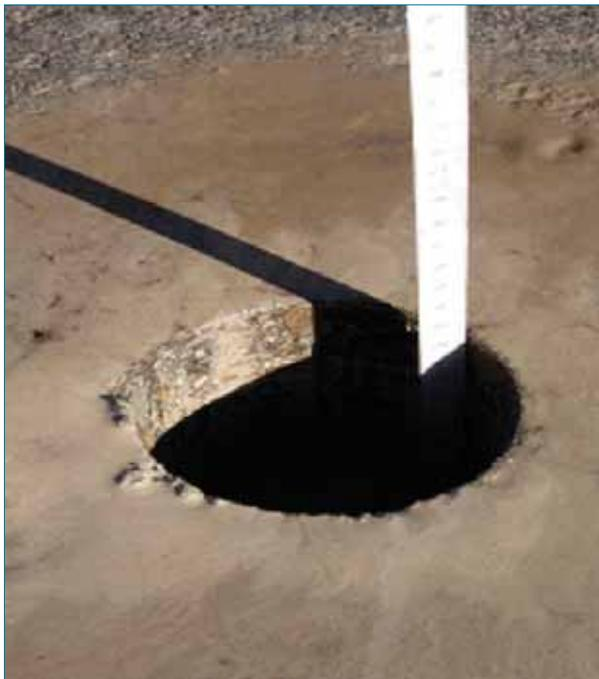
Figura 1: Detalle de la extracción de un testigo.
