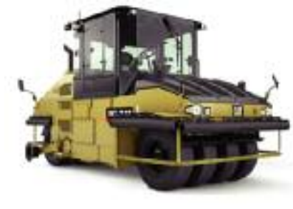
Rodillos metálicos lisos, compactadores de neumáticos y rodillos mixtos utilizados en los equipos de compactación.
