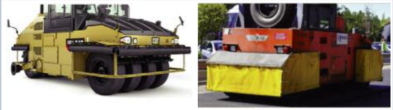
Detalle de los neumáticos de los compactadores.
