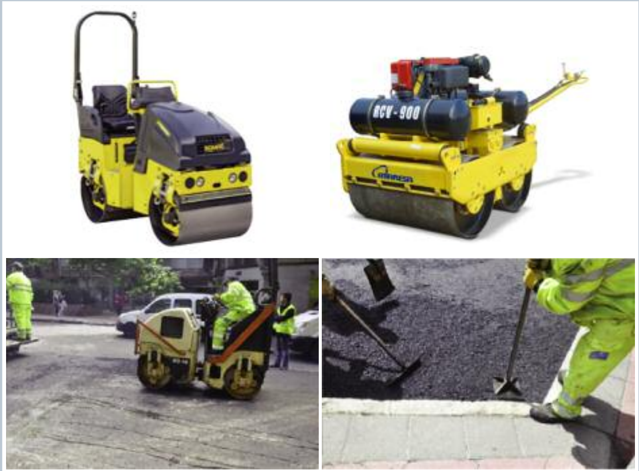
Pequeños equipos de compactación para zonas de difícil acceso.
