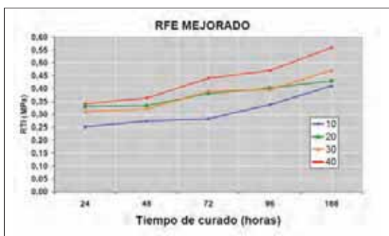
Figura 10. Resistencia a tracción indirecta vs. tiempo curado a cada temperatura compactación del reciclado mejorado.
