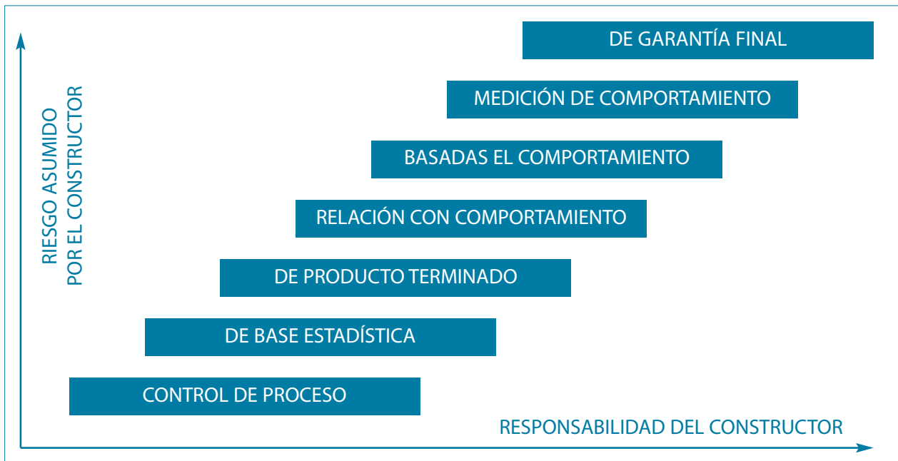
Figura 5: Riesgo y responsabilidad del constructor en función del tipo de especificación utilizado.
