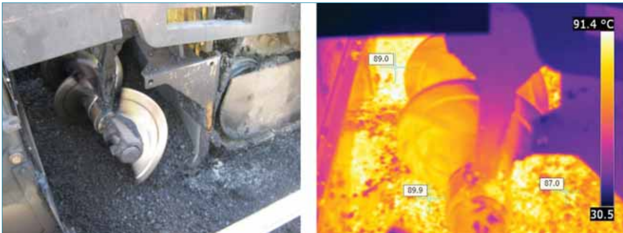
Figura 5. MBT: Termografía de la temperatura de la mezcla en el sinfín de la extendidora.
