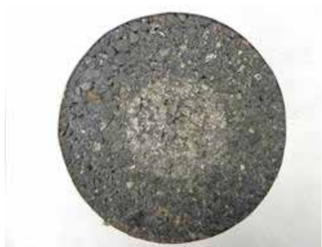
Figura 6: Muestra de un testigo antes de su pulido (izq.) y después de su pulido (dcha.).
