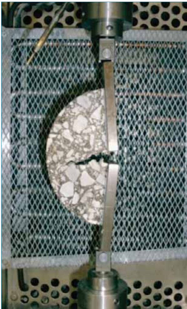
Figura 3. Montaje del ensayo Fénix.
