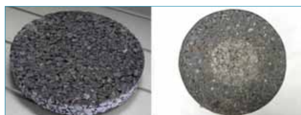
Figura 6: Muestra de un testigo antes de su pulido (izquierda) y después de su pulido (derecha).
