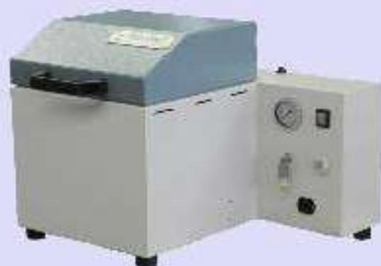
**EQUIPO PARA ENVEJECIMIENTO DE PROBETAS ASFÁLTICAS (SATS)**
