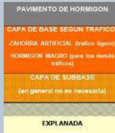
Figura 4: Sección tipo de un firme RÍGIDO
