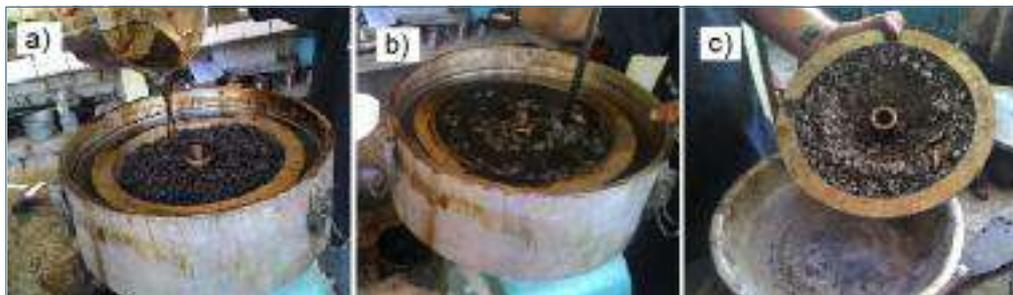
Figura 1: Remoção do betume da mistura asfáltica: (a) Mistura do solvente; (b) Rotação do equipamento; (c) Agregados após ensaio.
