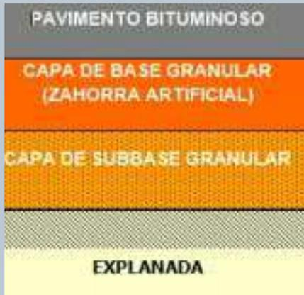
Figura 2: Sección tipo de un firme FLEXIBLE
