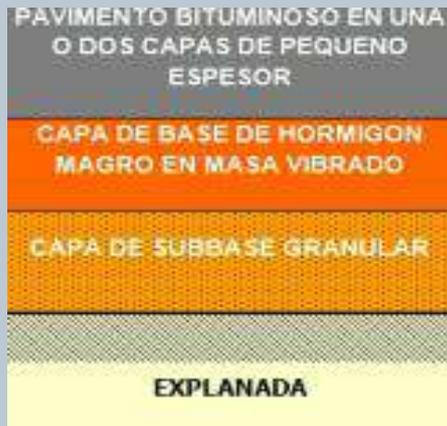
Figura 5: Sección tipo de un firme MIXTO
