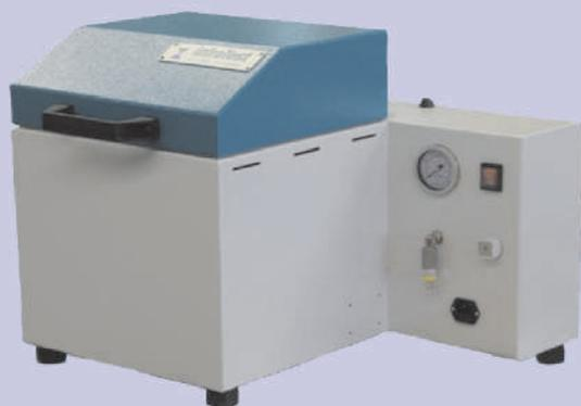
**EQUIPO PARA ENVEJECIMIENTO DE PROBETAS ASFÁLTICAS (SATS)**
