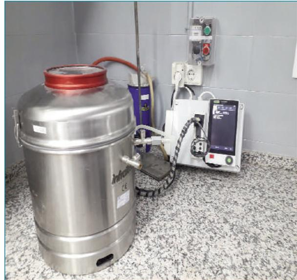
Figura 1. Equipo para la determinación de la densidad máxima por el método volumétrico
