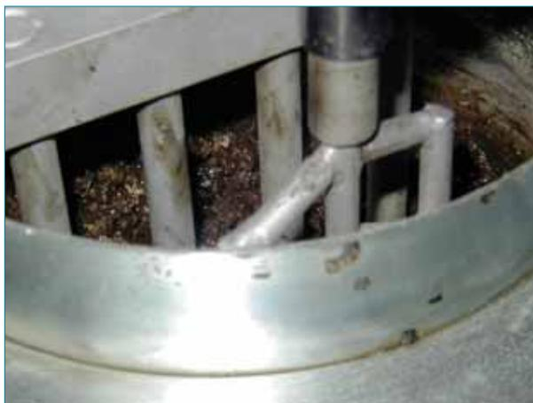
Figura 1. Equipo empleado para el mezclado de los diferentes materiales que componen una mezcla bituminosa.
