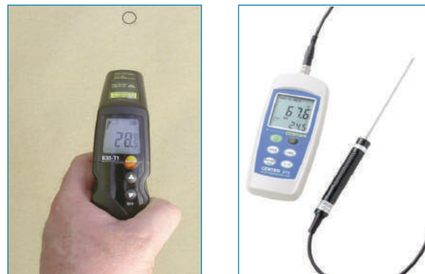
Figura 8: Equipo de medición IR (izquierda) y termómetro digital con sonda Pt 100
