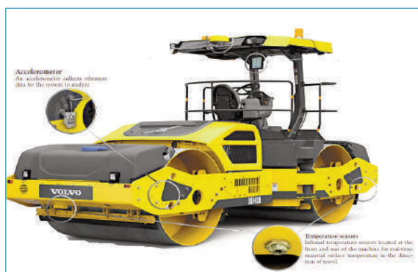
Figura 7. Compactador "inteligente" con sensores IR de temperatura. Fuente Volvo
