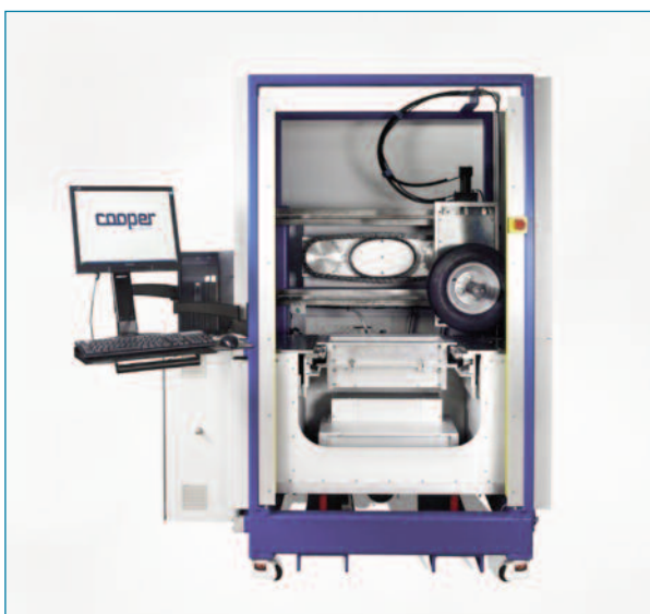
Foto 1. Compactador de rueda neumática.
