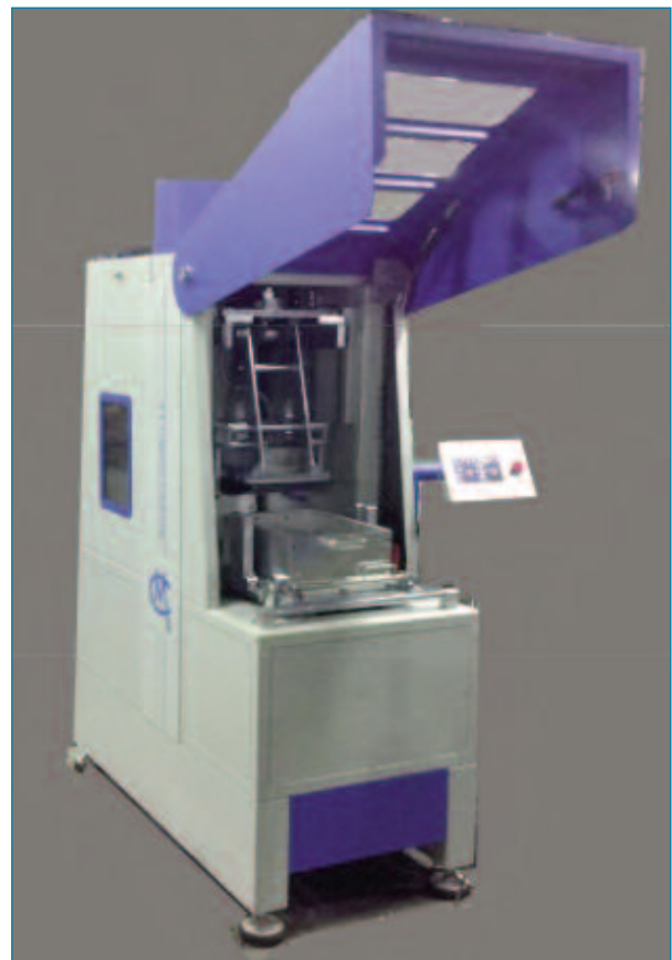
Foto 2. Compactador de segmento.
