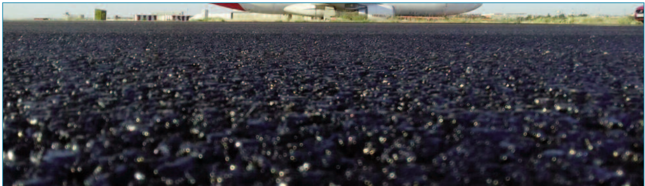
Figura 6. Fotografía de la textura final de mezcla SMA.
