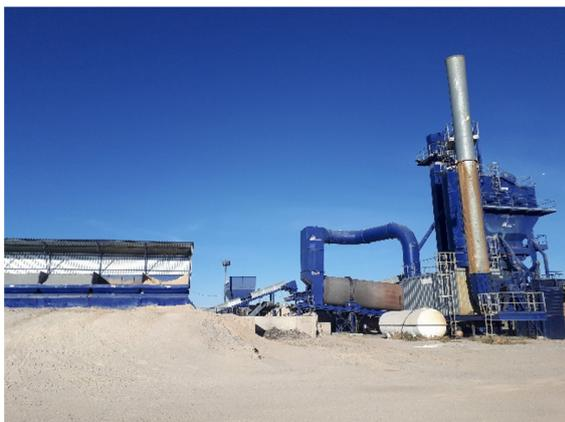
La fabricación de la mezcla se efectuó desde una planta Asfáltica ubicada en Algete (Madrid). Es una planta de fabricación de mezclas bituminosas discontinua, de la marca Intrame y modelo RM260. Se utilizaron 3 tolvas de alimentación de los áridos en frío,
