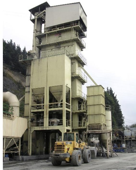
La mezcla se fabricó desde la planta asfáltica de Andoain (Gipuzkoa), con una planta asfáltica discontinua, de la casa comercial de Intrame de 260 t/h, con doble línea de alimentación y almacenamiento de áridos para capas base o intermedias y para capas de rodadura. Las fibras se introdujeron a través de un dispositivo especial de incorporación de aditivos direc-
