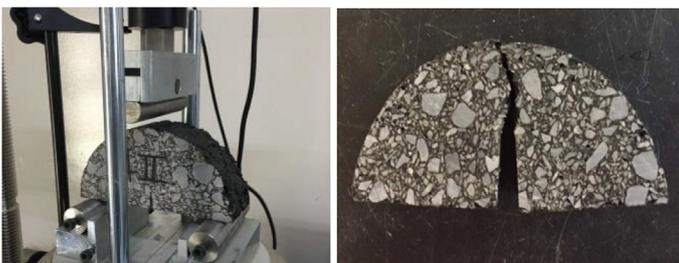
Figura 7. Probeta semicircular dispuesta en la prensa de ensayo, y detalle de la misma una vez finalizado.
