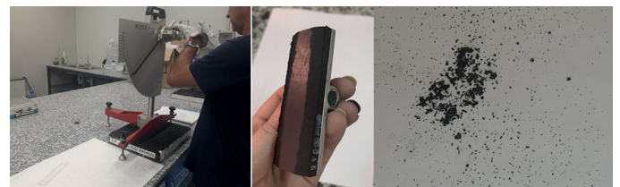
Fotografías 5. Péndulo de fricción. Detalle de las pastillas de caucho utilizadas y su desgaste mediante el ensayo con el péndulo de fricción
