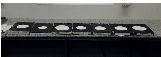
Fotografía 1. Detalle de la realización ensayo del círculo de arena
